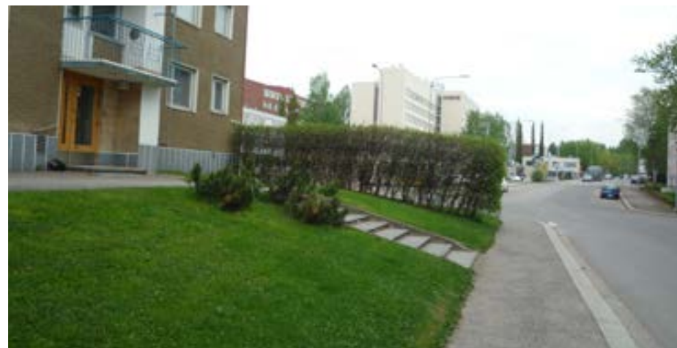
Kuva: As.oy Sammonkatu 29-31:n etupihalla Joukahaisen kadun varrella on Kalevaan sopivia pintamateriaaleja: nurmi, asfaltti, liuskekivi ja graniittireunakivi
